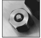
**Válvula de trabajo (3).** Es el embolo rojo con anillas, sujete y tire de él hacia el exterior, notará una pequeña resistencia y verá salir los anillos indicadores de presión, al soltar, el embolo recuperará su posición inicial rápidamente.
